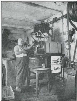
Fig. 3. — Four électrique utilisé pour le traitement des aciers destinés à la fabrication des limes.
